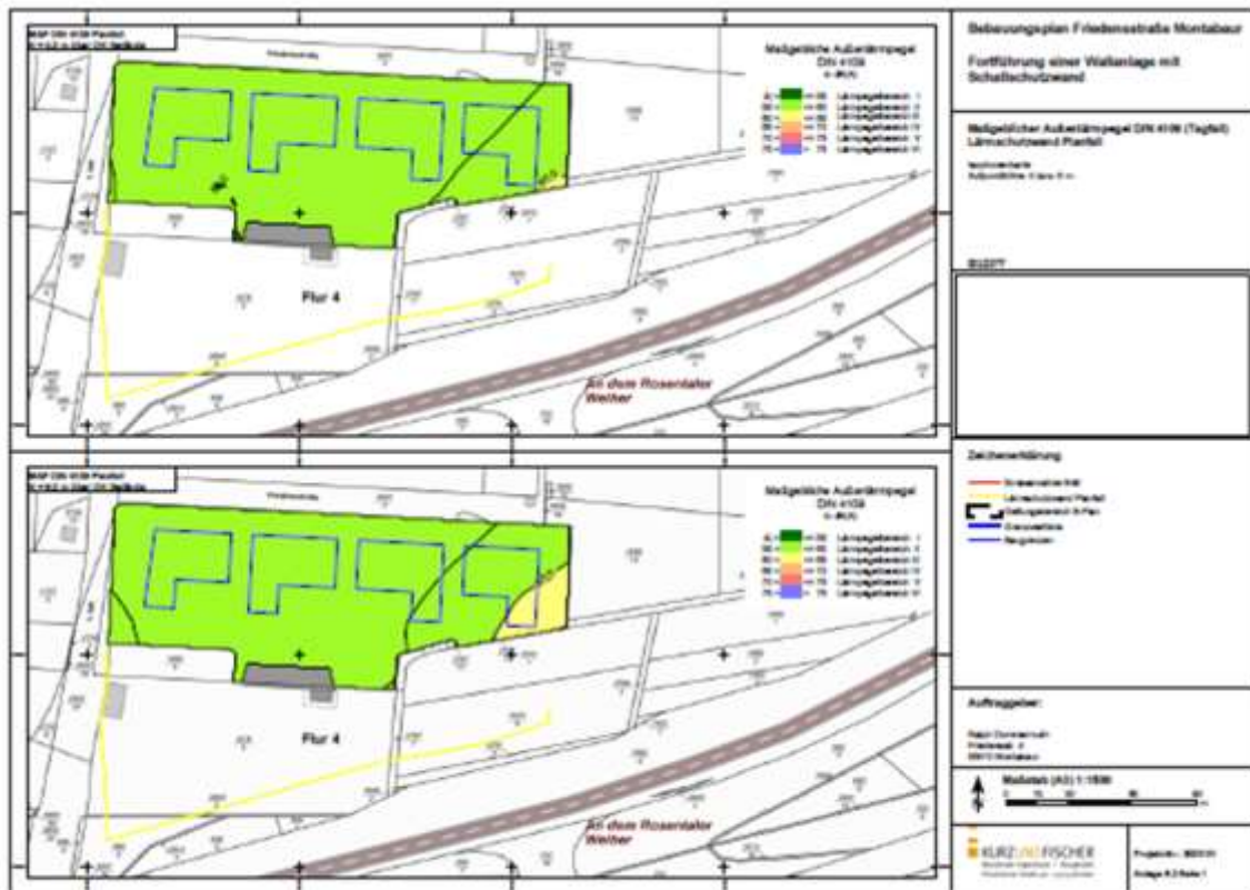
Abb. 6 Maßgeblicher Außenlärmpegel DIN 4109 (Tagfall) Lärmschutzwand Planfall
