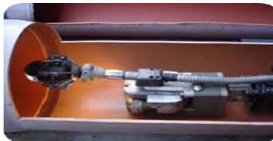
Zumeist ist es am Günstigsten, die Hausanschlussleitung mit einer Satellitenkamera vom öffentlichen Kanal aus zu untersuchen. Weiterführende Grundleitungen werden vom Revisions- bzw. Übergabeschacht aus mit einer Stabkamera inspiziert.
