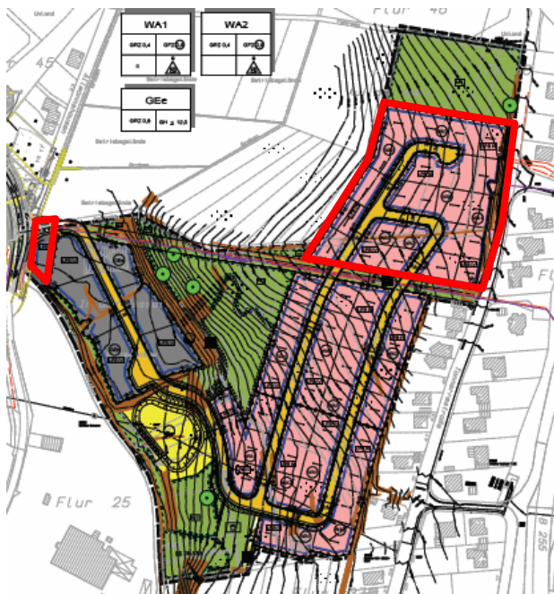
Abbildung 1: Teilbereiche des Plangebietes, in denen für die - von der jeweils maßgeblichen Lärmquelle - abgewandten Gebäudeseite der Lärmpegelbereich um eine Stufe herabgesetzt werden kann.
